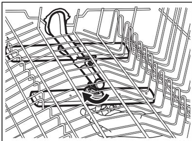
3. Operite mlaznicu pod tekućom vodom. Upotrijebite tanak šiljasti alat, npr. čačkalicu, za uklanjanje čestica prljavštine iz rupa.
