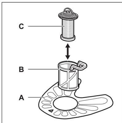
1. Okrenite filter (B) u smjeru suprotnom od smjera kazaljki na satu i skinite ga.
