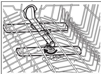
3. Ostříkovací rameno omyjte pod tekoucí vodou. Pomocí tenkého špičatého nástroje, např. párátko, odstraňte nečistoty z otvorů.
