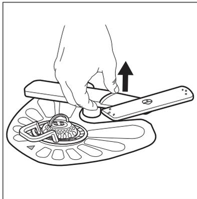
2. Ostříkovací rameno omyjte pod tekoucí vodou. Pomocí tenkého špičatého nástroje, např. párátko, odstraňte nečistoty z otvorů.
