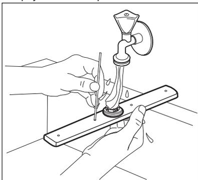
4. Za vraćanje mlaznice, umetnite element za montažu u mlaznicu i pričvrstite je u utor okretanjem u smjeru obrnutom od kazaljki na satu. Pazite da element za montažu sjedne na mjesto.
