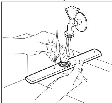
4. Ostříkovací rameno nainstalujete zpět tak, že úchytný prvek vsunete do ostříkovacího ramena a upevníte ho v trubce otočením proti směru hodinových ručiček. Úchytný prvek musí zaklapnout na místo.
