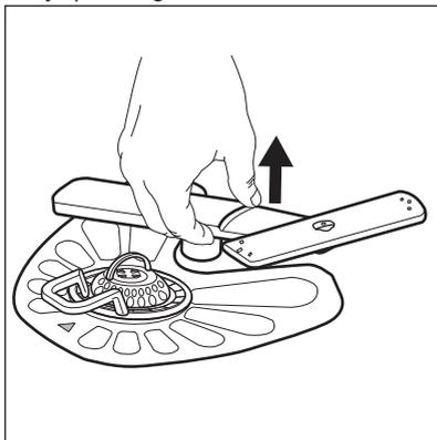
2. Mlaznicu isperite pod tekućom vodom. Za uklanjanje čestica prljavštine iz rupica upotrijebite alat sa šiljkom, npr. čačalicu.
