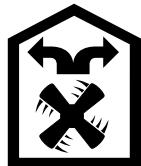
Usisani zrak čisti se prolaskom kroz filter za masnoću i filter s aktivnim ugljenom te se ponovno dovodi u kuhinju.
