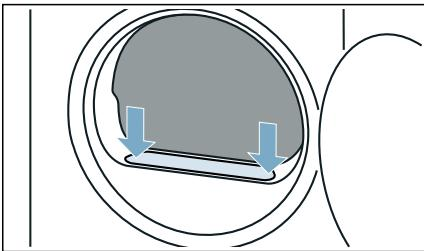
4. Razvucite dvodijelni filter za niti.
