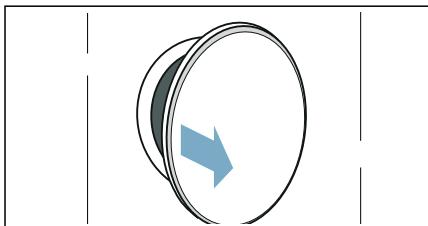
2. Senzor vlage očistite hrapavom stranom spužvice.
