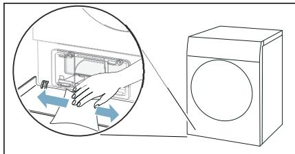
3. Odbravite ručice na poklopcu izmjenjivača temperature.
