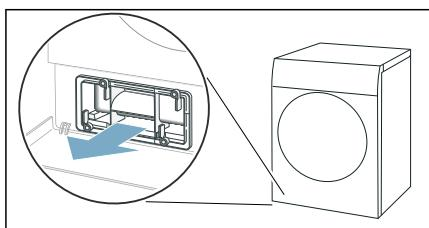
5. Mekom četkom očistite poklopac izmjenjivača temperature.
