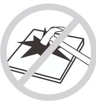
Si la surface est fêlée, éteindre l'appareil pour éviter les risques d'électrocution.
