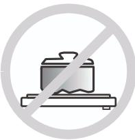
Non collocare recipienti ruvidi o irregolari sul piano di cottura, poiché potrebbero danneggiare la superficie ceramica.
